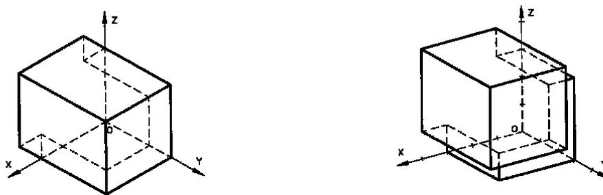
Figura 1-2. Proyecciones de un objeto poliédrico sin respetar (izquierda) y respetando (derecha) la convención del punto de vista general.
