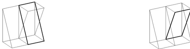
El corte de estos dos bucles de caras se traduce en la figura siguiente mediante una arista de corte que nos deja el siguiente modelo alámbrico y, además provoca que los dos bucles de caras se dividan como se indica a continuación:
